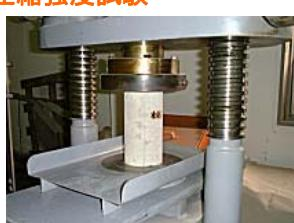
受入検査時に供試体を取り、これを使って1週間後、4週間後に圧縮強度試験を行い、計画されている強度を発現しているか確認します。
